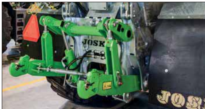
Relevage Lift intégré à la cuve sur VOLUMETRA
