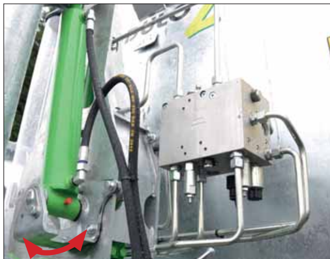
Pour changer de côté, il suffit de déplacer la base du vérin de droite à gauche
