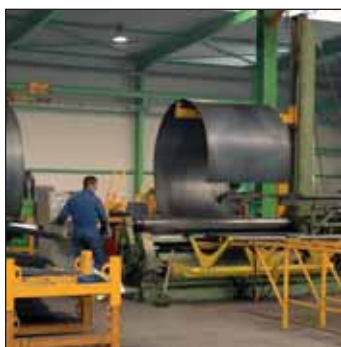
Cintrage de la tôle (cintruse à commande numérique)
