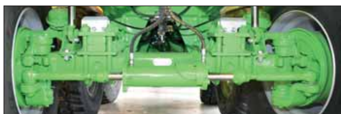
Essieu directionnel forcé (100 % directionnel)
