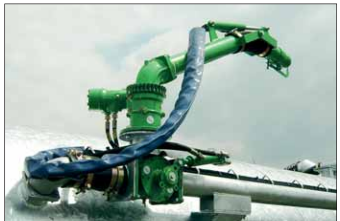
Agitation volumétrique avec retour en cuve par vanne 3 voies hydraulique
