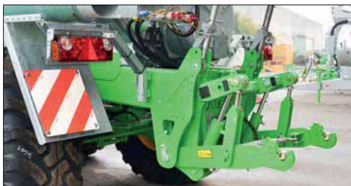
Relevage Lift intégré (relevage complètement intégré au châssis) sur QUADRA, X-TREM, VOLUMETRA, TETRAX et EUROLINER
