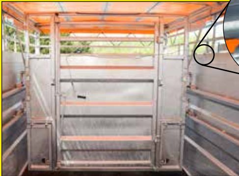
Porte intérieure équipée d'une poignée pour une ouverture en toute sécurité depuis l'extérieur
