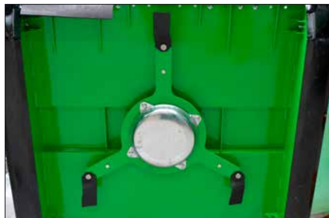
Les broyeurs BEV sont équipés d'un rotor supportant 3 couteaux de "type TD"
