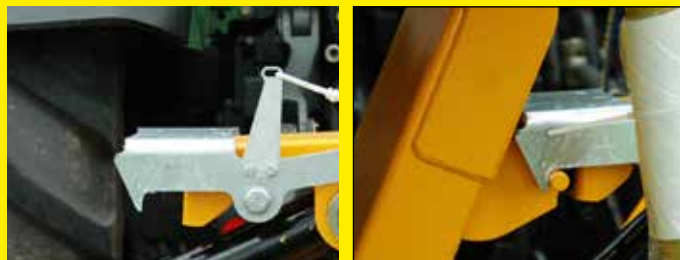
Pour la sécurité lors des déplacements, un verrouillage mécanique empêche l'ouverture des bras porteurs
