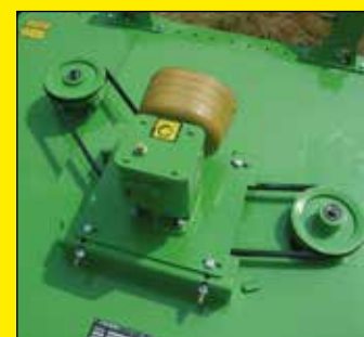
La transmission est assurée par 2 courroies trapézoïdales qui entraînent les différents rotors d'entretien.
