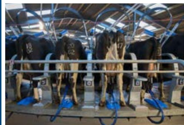
La technologie Top Flow™ DeLaval est intégrée dans les faisceaux trayeurs Evanza™ disponibles pour une utilisation avec le Système ROTO E100 DeLaval. Le lait s'écoule doucement au fond de la griffe, puis il est extrait directement par une tubulure centrale connectée au tuyau long à lait. Cette technologie évite les engorgements et assure la stabilité du vide ainsi que l'extraction rapide et en douceur du lait tout en préservant la qualité du lait.
