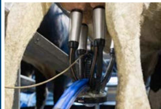
Le faisceau trayeur est le seul point de contact physique entre l'animal et la machine à traire. Ce qui se passe ici au point de contact des trayons et la façon dont l'extraction du lait se passe ont un impact à la fois sur la santé de la mamelle et sur la qualité du lait.
