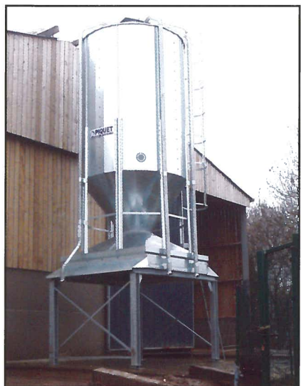
Silo galvanisé 3 aliments avec portique 3 stations
