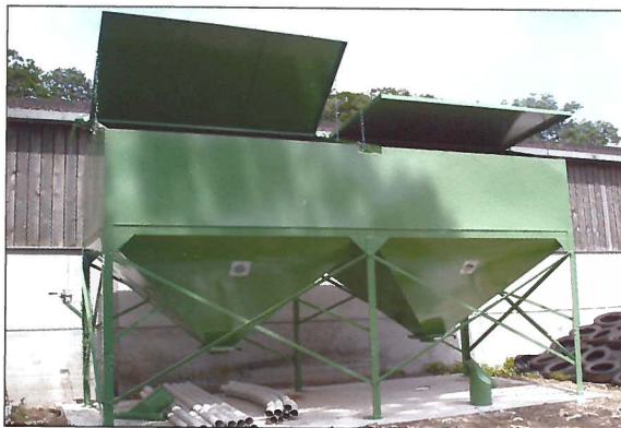
Ouverture manoeuvrée par treuils
