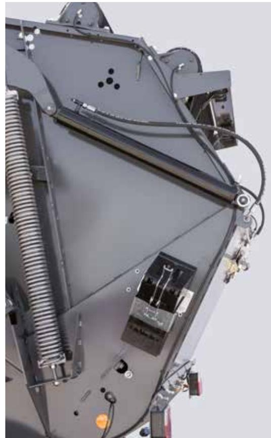
Le volume de la balle augmente exponentiellement par rapport à son diamètre, avec une pression de courroie correspondante, afin de maintenir une densité de balle constante.
