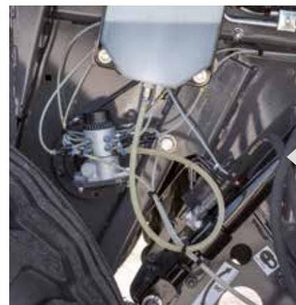
La lubrification automatique des chaînes, avec réglage individuel pour chaque chaîne, garantit une alimentation suffisante en huile, réduit le temps d'entretien et prolonge la durée de vie des chaînes. Et pour une durabilité renforcée, ces presses sont dotées des meilleures chaînes du marché.
