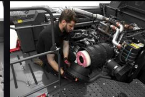
Contrôle et nettoyage du filtre à air
