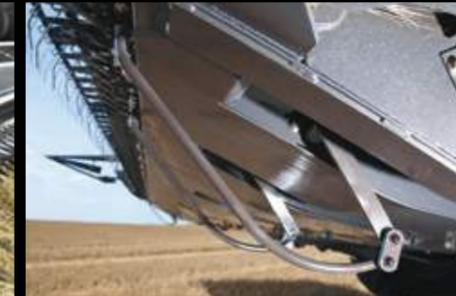
Le lamier se situe à 1,14 m de distance de la vis d'alimentation de la table de coupe afin d'offrir une visibilité et des performances optimales. Les robustes tapis PowerFlow transfèrent la récolte depuis le lamier jusqu'à la vis d'alimentation à vitesse constante, et se chargent également d'éjecter les pierres afin d'éviter tout endommagement de la machine.
