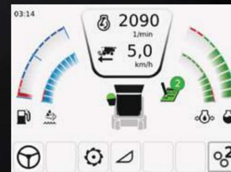
◀ L'écran d'Informations générales est constamment affiché dans le coin supérieur gauche du terminal. Le régime moteur et la vitesse d'avancement sont affichés à côté des jauges de carburant, d'AdBlue, d'huile et de température moteur. Un graphique affiche également le statut en temps réel de la trémie et de la vis de vidange.
