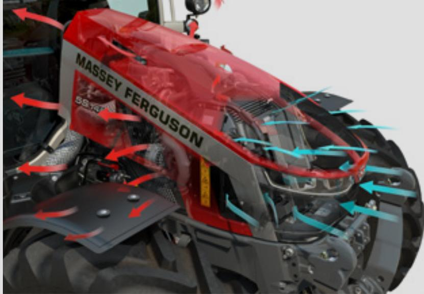
Un nouveau flux d'air permet d'améliorer le refroidissement du moteur pour plus de performance et d'efficacité. Grâce à la nouvelle calandre large, tous les radiateurs reçoivent de l'air frais, pour un refroidissement plus efficace.
