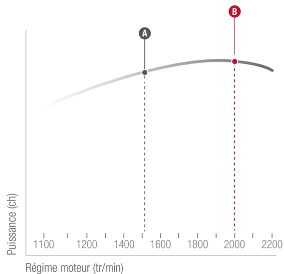
Les régimes de PDF ont été alignés avec les valeurs de couple et de puissance maximales offertes par le moteur AGCO POWER dans le but d'offrir plus de performance et une consommation de carburant réduite.
