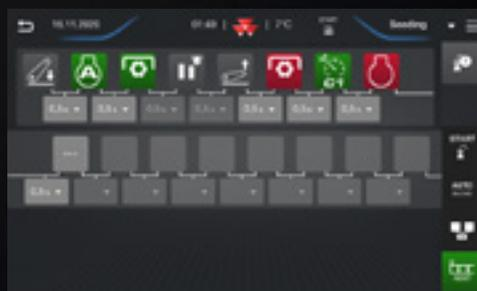
► **Gestion des manœuvres en fourrière** – Le terminal Datatronic 5 est doté de série du système de gestion automatique des manœuvres en bouts de champs le plus intuitif et le plus simple d'utilisation du marché. Il vous fait gagner un temps considérable lors des manœuvres en fourrière et vous permet de vous concentrer sur votre travail afin d'optimiser votre productivité.
