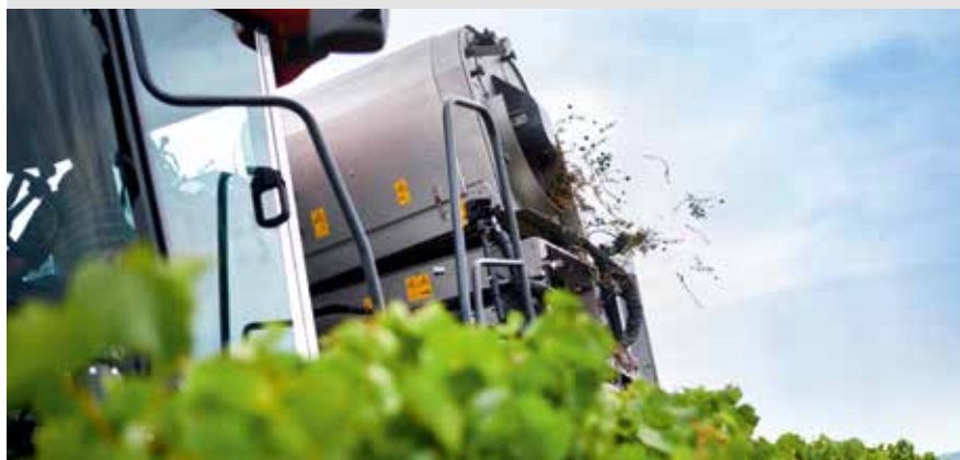
Basculement automatique du panier pour une répartition régulière des baies sur toute la surface de la table de tri même en forte pente.
