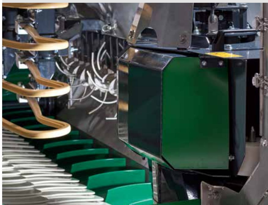
Paroi latérale de l'aspirateur flexible pour éviter les obstacles et prévenir ainsi les dommages.
