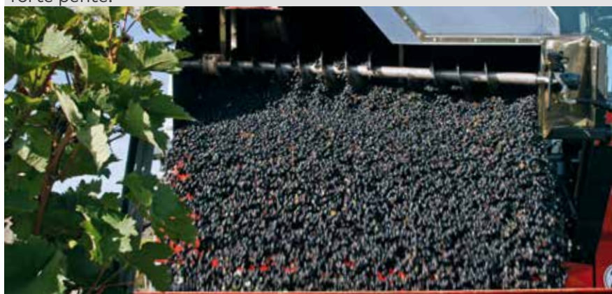
La largeur de vidage standard de 1,80 m peut être ramenée par paliers à un minimum de 85 cm.
