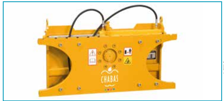
▲ Tête rotative 180° FEM II (Retournement par crémaillère et couronne actionnées par un vérin double effet / Rotation droite ou gauche / Accrochage par clavette)
