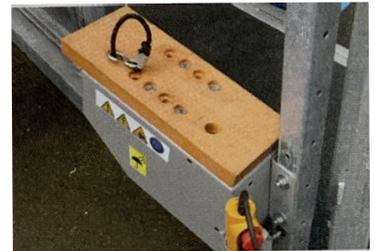
**Parage des pattes avant :** 2 treuils électriques carénés avec repose pied ergonomique en bois traité et commande avec arrêt d'urgence.
