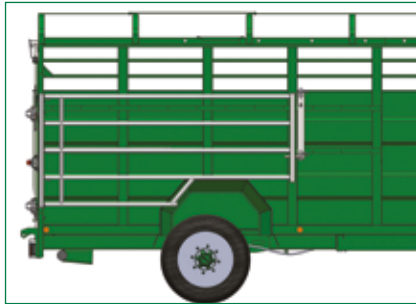
Modèle HSRB 5390 équipé de barrières ext. 3/4 m avec découpe passage de roue.
