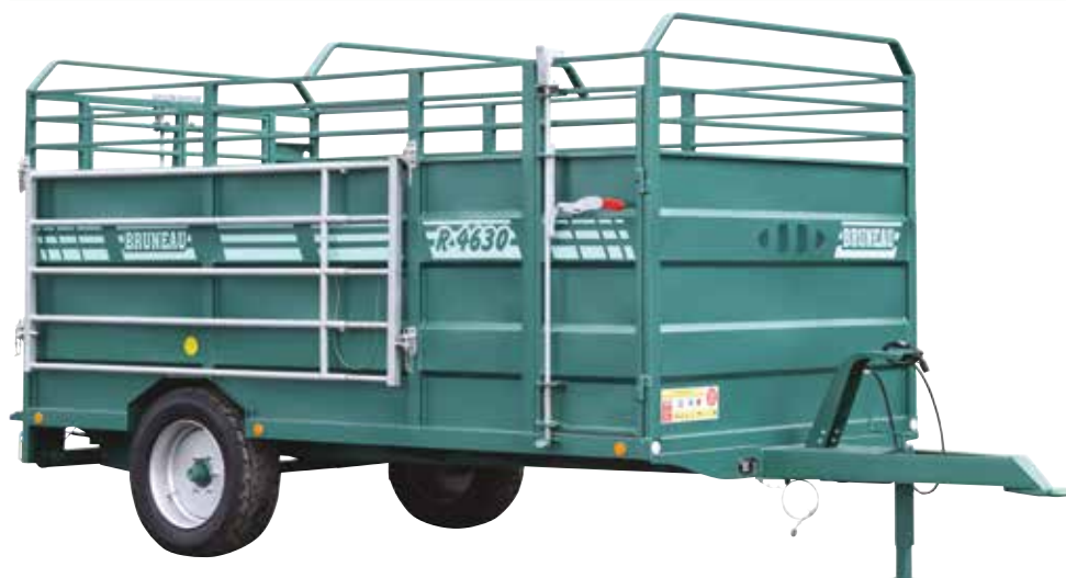
R4630 avec option barrières latérales sur chapes et pont arrière rabattable assisté par verins à gaz
