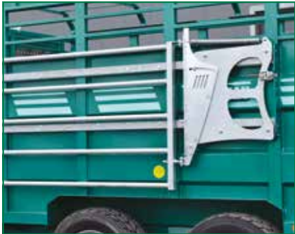
Modèle SRB 5390 équipé de barrières SANS découpe de passage de roue.
