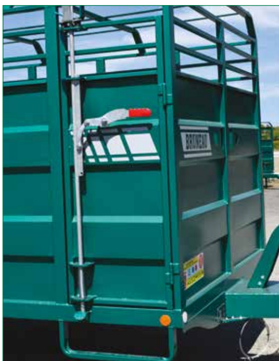
Porte latérale avant largeur 0,67 m avec mécanisme automatique de fermeture. Porte équipée d'un marche-pied
