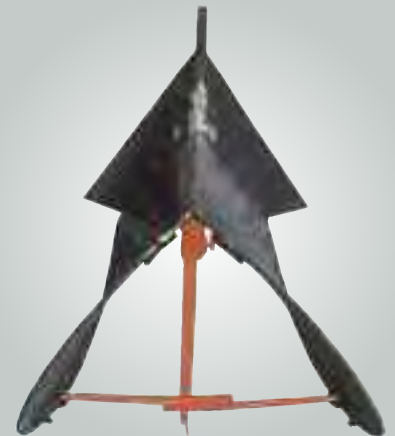
Buttoir avec : • versoirs réglables • pointe mobile
