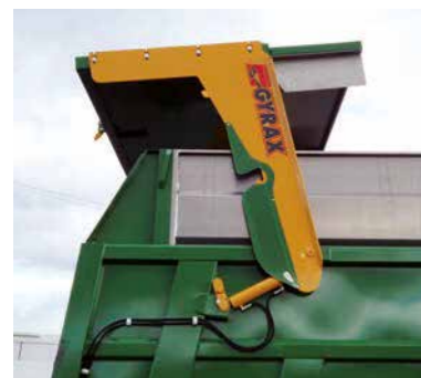
Porte hydraulique à grand dégagement Hydraulic door offering generous clearance
