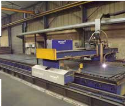
Découpes précises par Laser et Plasma Precision Laser and Plasma cutting
