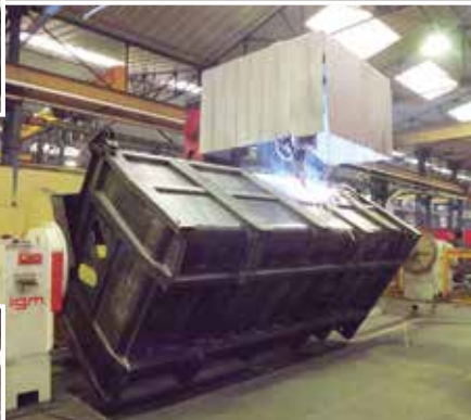
Soudures robotisées Welding by robots
