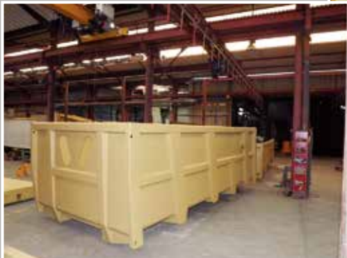
Grenailage intégral + antirouille + peinture polyuréthane = brillance et longévité Complete shot blasting + rust inhibitor + polyurethane paint = glossy finish and durability
