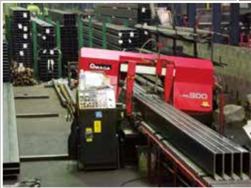
Découpe des tubes (futurs châssis) Tube cutting (future chassis)
