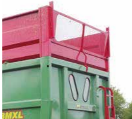
Partie avant grillagée et rabattable Folding mesh front part
