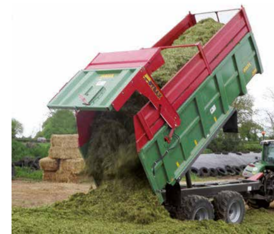
Porte hydraulique à grand dégagement Hydraulic door offering generous clearance
