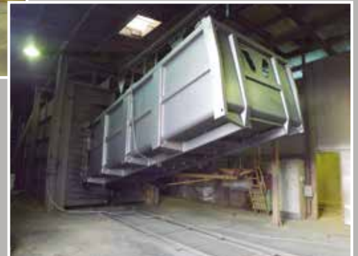
Grenailage intégral + antirouille + peinture polyuréthane = brillance et longévité Complete shot blasting + rust inhibitor + polyurethane paint = glossy finish and durability
