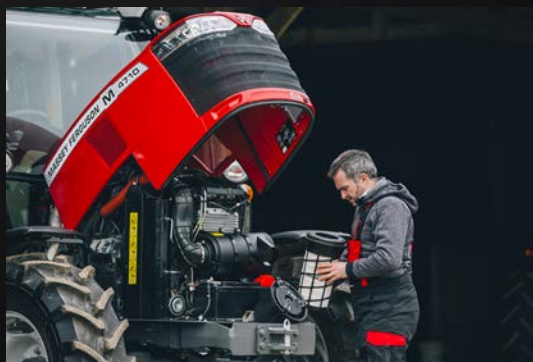
Accès et nettoyage faciles du filtre à air moteur.
