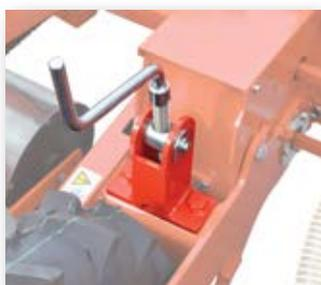
Réglage de la hauteur de roue d'entraînement
