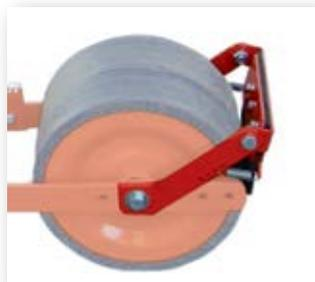
Décrottoir de roue de rappui
