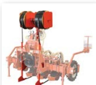
Kit pour la dépose des gouttes à gouttes
