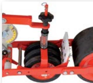
Roue plombeuse en caoutchouc souple, triple ligne. ORIETTA W.
